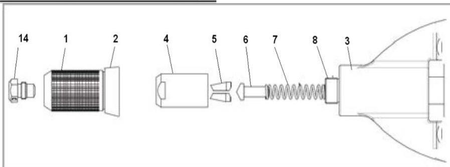
1. Отпустите регулировочную гайку (№2) и выверните переднюю часть корпуса (№1) из корпуса (№3)
