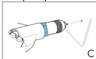
4. Сведите пантограф (№11) установочного инструмента, так чтобы произошел разрыв сердечника заклепки (рис. D)
